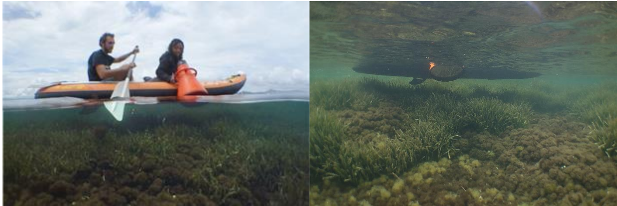
Figure 2-12. Vérité terrain réalisée à partir d'un kayak de mer et muni d'une lunette de calfat et d'un GPS.
