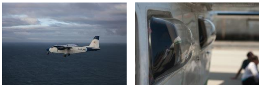
Figure 5. Avion BN2 British Norman Islander utilisé pour les suivis et Hublots bulles pour l'observation aérienne (Photos : SEE)
