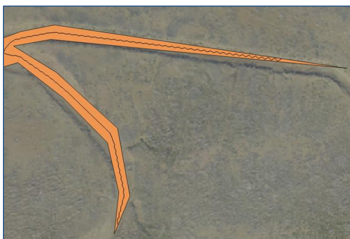
Figure 24 : Effet « dent de scie » aux extrémités des filandres
