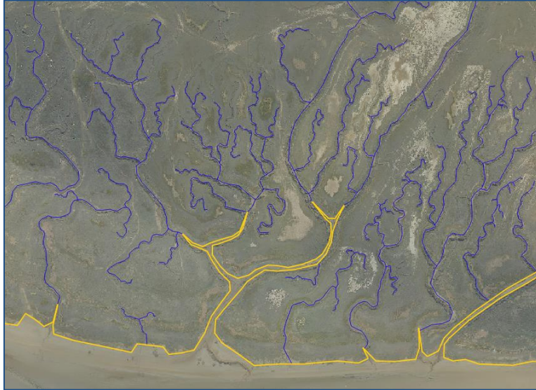
Figure 8 : Numérisation des filandres de largeur inférieure à 2 m (en bleu)
