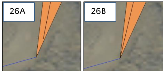
Figure 26 : Exemple d'un accrochage d'une extrémité du squelette à une petite filandre
