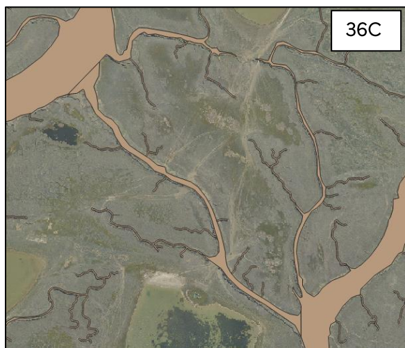
Figure 36 : Exemple de découpe d'un chenal de filandre : chenal avant découpe (36A), découpe du chenal selon l'embouchure (en rouge, figure 36B) et résultat de découpe (36C)
